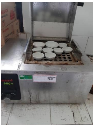
Uapkan dalam tangas air suhu 35°C hingga menguap
