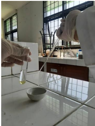
Masukkan lapisan organik ke dalam cawan uap
