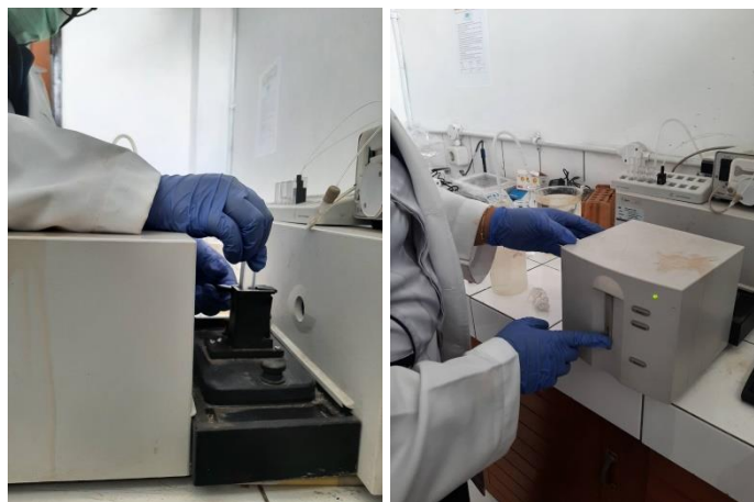
Mengukur absorban sampel di spektrofotometer UV
