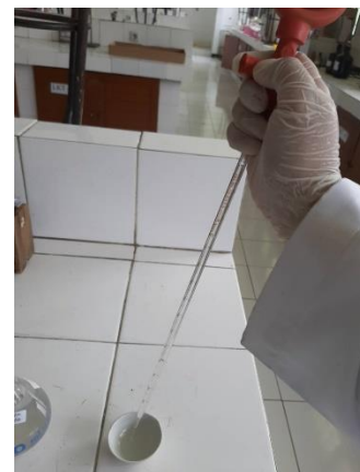
Menambah buffer fosfat pada cawan uap
