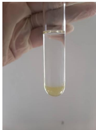
Terdapat pemisahan 2 lapisan yaitu lapisan atas dan lapisan bawah
