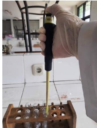
Menambah NaOH 5M ke dalam tabung reaksi
