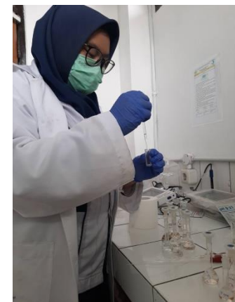
Menuangkan sampel dari labu ukur ke kuvet
