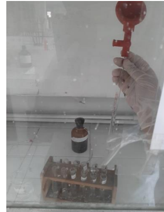
Menambah campuran diklormetan-dietileter (1:1) ke dalam tabung reaksi di ruang asam
