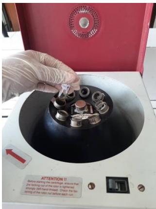
Sentrifugasi pada kecepatan 3000rpm selama 2 menit
