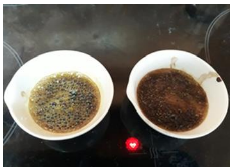
Proses destruksi di atas hotplate dengan skala 4
