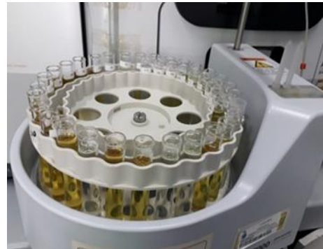
Penempatan sampel pada disk spektrofotometer serapan atom (SSA)
