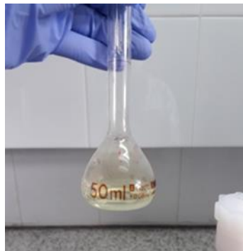
Hasil destruksi dengan microwave digestion
