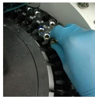
Gambar 22. Simpan Sampel pada Tray Cobas C311
