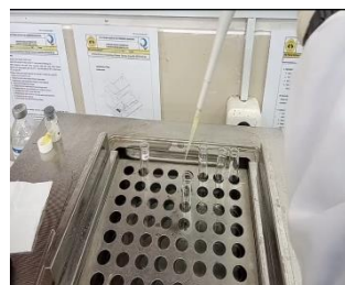
Proses pemeriksaan PT dengan menggunakan metode manual
