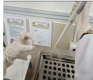
Proses pemipetan reagen PT yang akan diinkubasi sebelum digunakan
