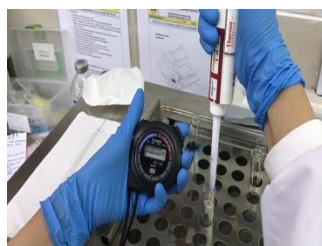
Masukan sampel 100 \mu L kedala tabung diamkan 2 menit
