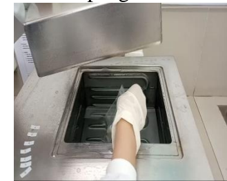
Sampel dimasukan kedalam waterbath untuk pencairan
