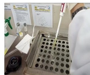
Proses pemipetan reagen PT yang akan diinkubasi sebelum digunakan
