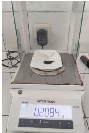
Menimbang 0,2 gram MB untuk dilarutkan dalam 10 mL sitrat salin
