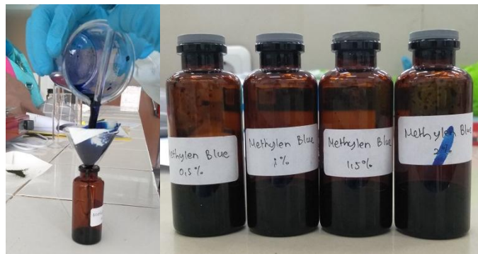
Penyaringan Methylen Blue dan reagen Methylen Blue 0,5%, 1%, 1,5%, 2%.
