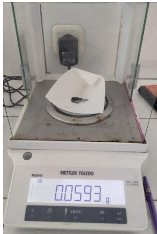
Menimbang 0,05 gram MB untuk dilarutkan dalam 10 mL sitrat salin
