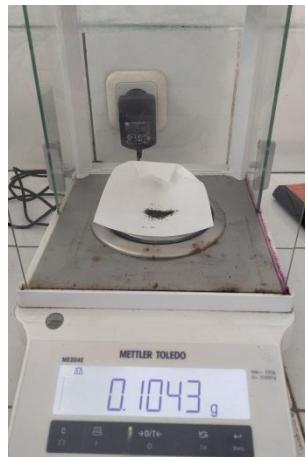
Menimbang 0,1 gram MB untuk dilarutkan dalam 10 mL sitrat salin
