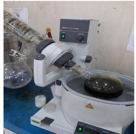
Pembuatan ekstrak daun sirih hijau dengan rotary evaporator
