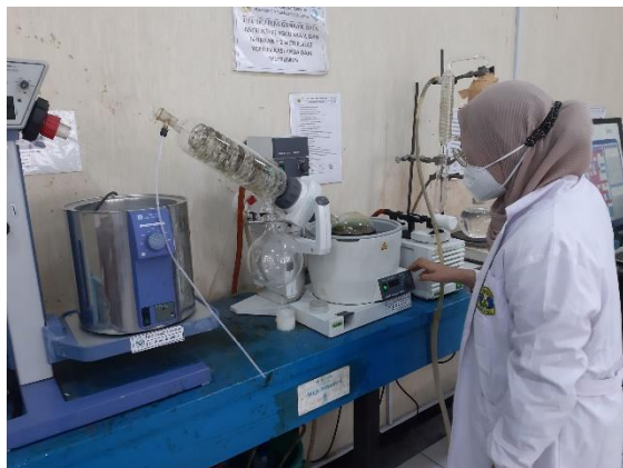
Proses pembuatan ekstrak daun sirih hijau dengan rotary evaporator
